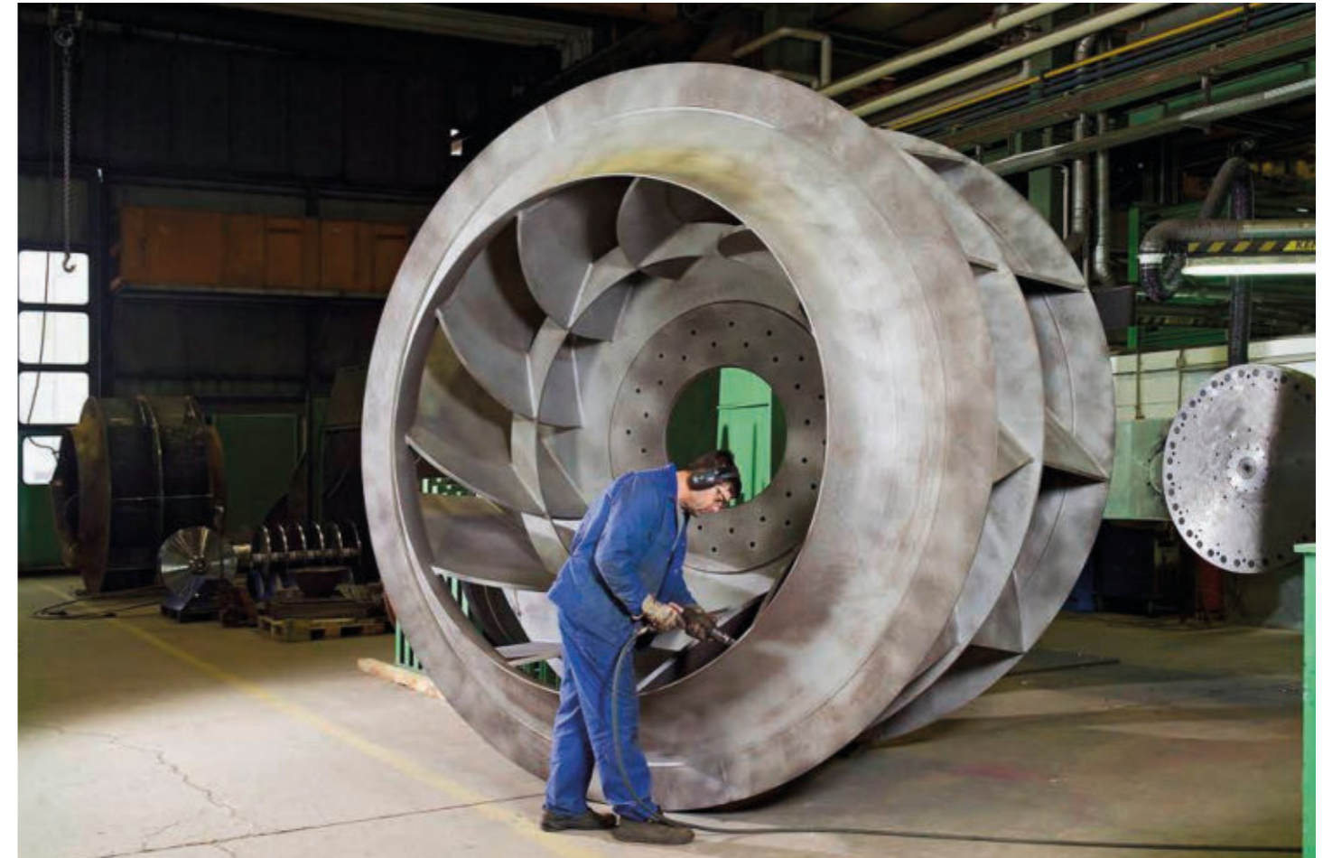
Die Basis für hohe Wirkungsgrade: dem Prozess bis ins Detail angepasste und optimierte Laufradformen (hohe Wirkungsgrade im Teillastbereich durch Einsatz der Drehzahlregelung)
