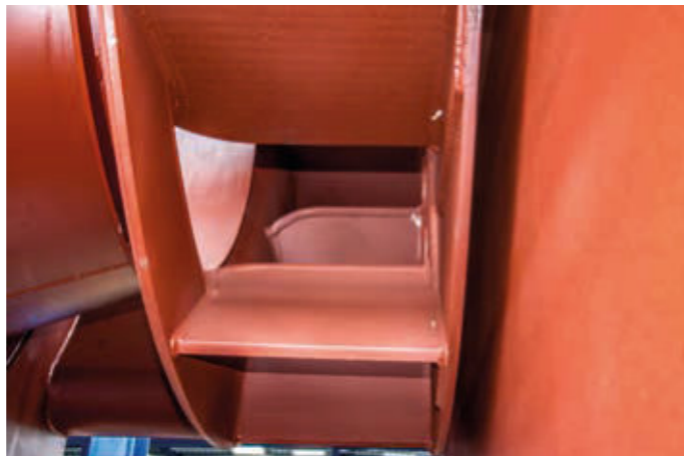
Spezielle Oberflächenstrukturen, Materialien und Geometrien minimieren die Anbackungen abrasiver Feststoffe und erhöhen die Standzeiten.
